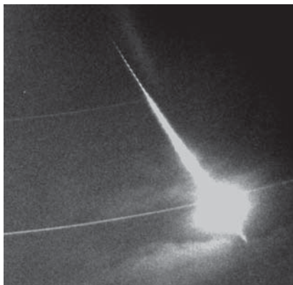
Obr. 1: Detailní snímek bolidu EN040207 ze 4. února 2007 pořízený automatickou bolidovou kamerou Astronomického ústavu AV ČR na stanici Červená hora u Moravského Berouna. Přerušování světelné stopy bolidu je způsobeno rotujícím sektorem a umožňuje přesné určení rychlosti a jejího průběhu během průletu tělesa atmosférou Země. V maximu bolid dosáhl jasnosti -18. magnitudy ve výšce 36 km nad zemským povrchem (Dr. Pavel Spurný).
